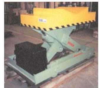
⑨ Carros elevadores motorizados para carga-descarga de bobinas en líneas de producción. 0,5 a 100 t.
