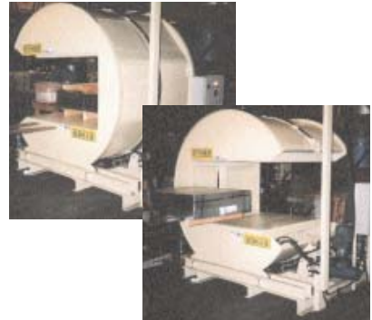
③ Volteadores de 180° para paquetes de chapa, papel, palets, etc. 0,5 a 15 t.
