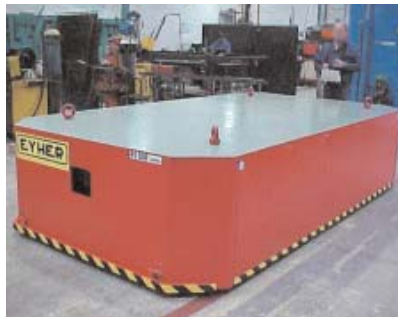
⑤ Carros motorizados con tracción y dirección. Capacidad: 1,5 a 50 t.
