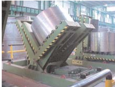
② Volteadores de 90° para paletizar y despaletizar bobinas. 0,5 a 30 t.
