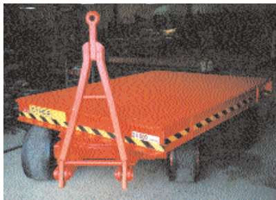
④ Remolques industriales para arrastre con carretilla elevadora o tractor. 1,5 a 200 t.
