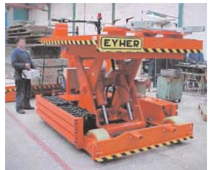
⑥ Carros elevadores motorizados para transporte y cambio rápido de troqueles en prensas. 1,5 a 50 t.
